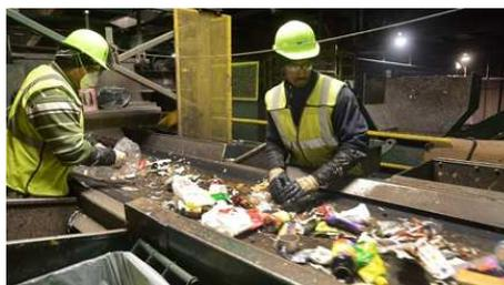
Roztriedené druhy plastov vrátane zmesi plastového odpadu, ktoré zostanú po prvotnom pretriedení, sa lisujú do balíkov a odvážajú na spracovanie k recyklátorom. Výsledkom recyklácie plastov býva vo väčšine prípadov tzv. regranulát. Je to vstupná surovina na výrobu nových plastov.
